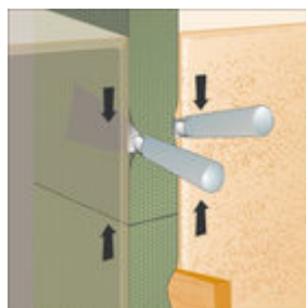
Ilustracja 2: Sposób połączenia dwóch końców taśm ze sobą.
