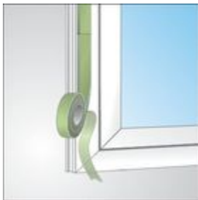
Ilustracja 3: Sposób połączenia dwóch taśm ze sobą.
