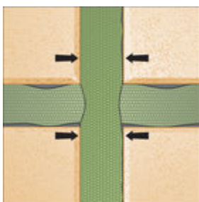
Ilustracja 4: Połączenie krzyżowe taśm. Fuga fasadowa.
